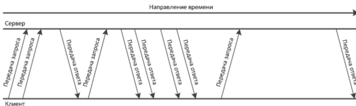
Рис. 4. Схема взаимодействия Streaming
