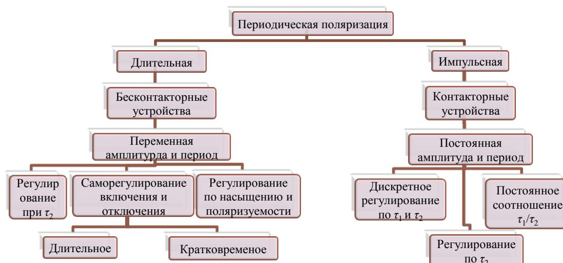
**Рис. 2.** Классификация методов регулирования при периодической поляризации защищаемого объекта:  $\tau_1$  – время включения тока,  $\tau_2$  – время отключения тока.
