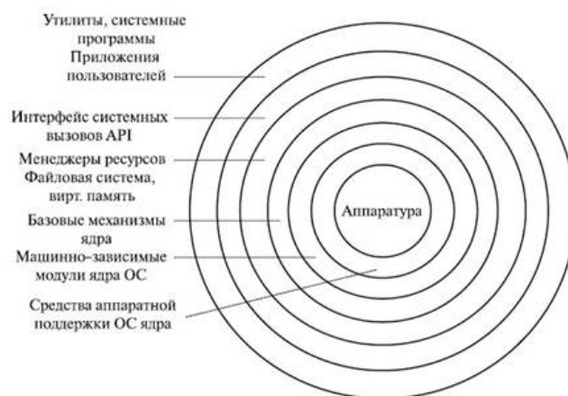
Рис. 4. Многослойное строение ядра
