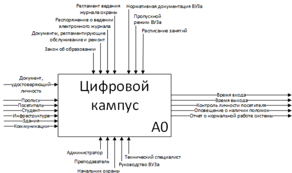
Рис. 2. Экранная форма контекстной диаграммы главной функции цифрового двойника ЮРГПУ (НПИ)
